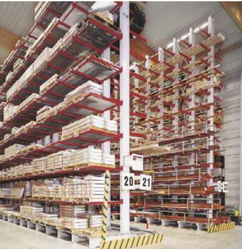
Kragarm-Doppelregal mit Gitterrostauflagen – Abfallsicherungen schützen das Lagergut gegen Herausfallen. Branche: Heizungs- und Sanitärgrößhandel
