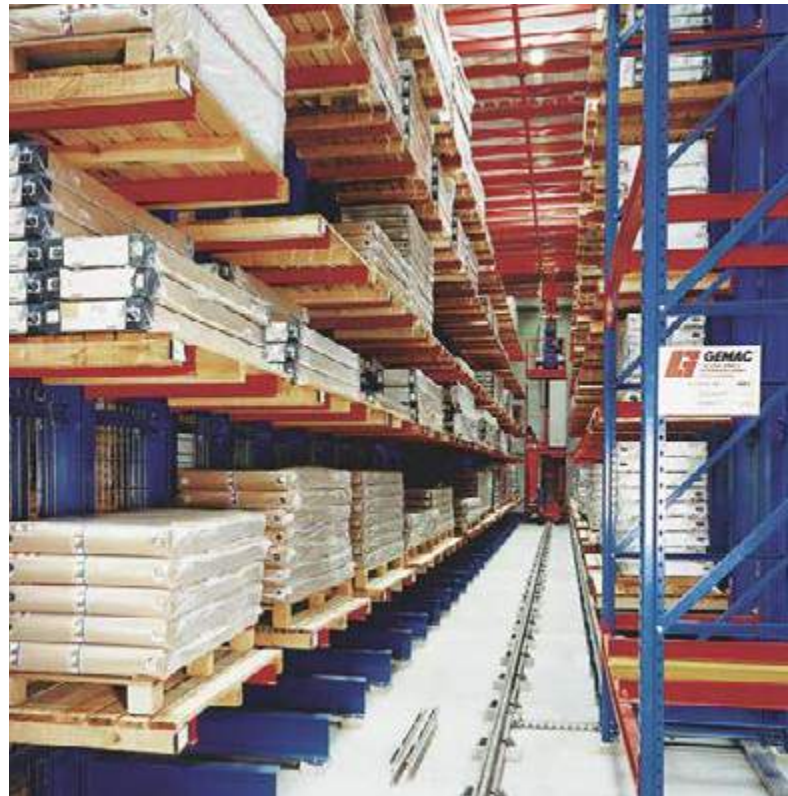
Kragarm-Einfachregal mit schienengeführtem RBG. Branche: Heizungs- und Sanitärgrößhandel
