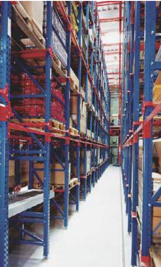
Einplatz-Palettenregal mit schienengeführtem RGB. Branche: Heizungs- und Sanitärgrößhandel
