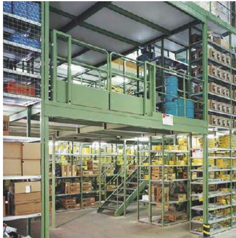
3-geschossige Fachbodenregalanlage mit Treppenaufgang und Schutzgeländer. Branche: Maschinenbau
