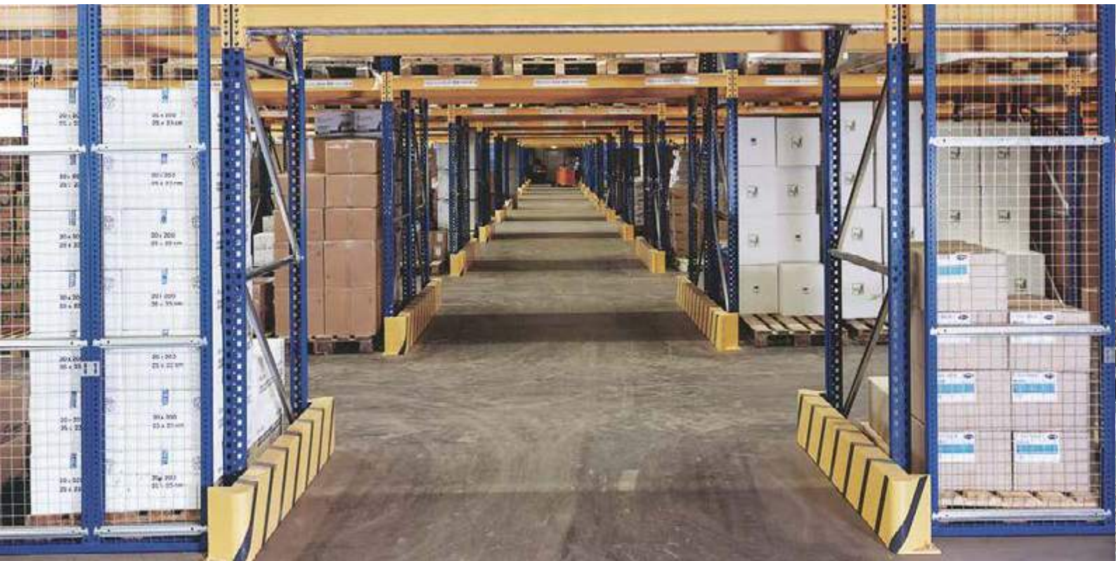
Mehrplatz-Palettenregale – Hauptdurchgang mit Sicherheitseinrichtungen. Branche: Medizinischer Handel
