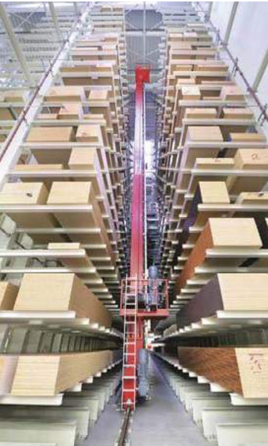
Vollautomatische Kragarmregalanlagen. Branche: Möbelindustrie
