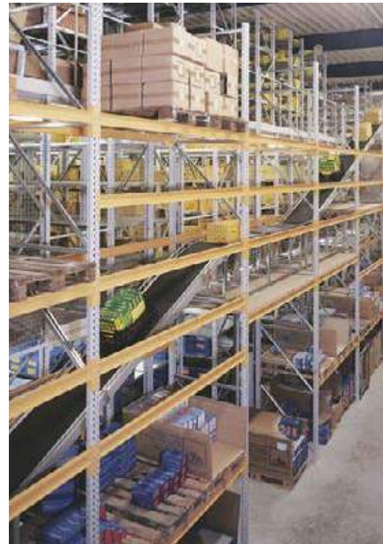
Mehrplatzpalettenregal mit integrierter Förderstrecke. Branche: KFZ-Teilehandel
