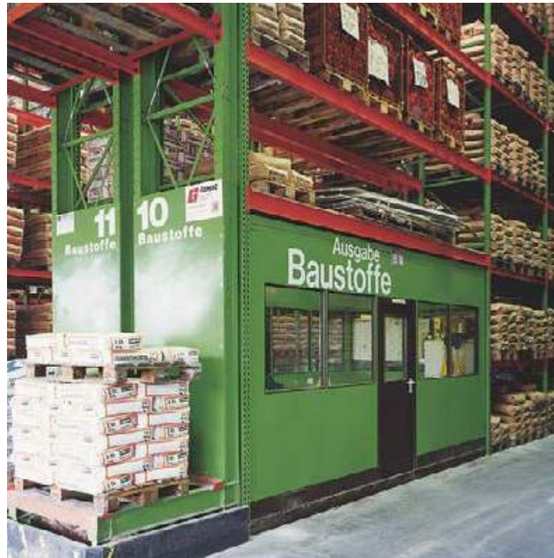
Mehrplatz-Palettenregal mit Übergabestation und integriertem Meisterbüro. Branche: Baustoff-Handel
