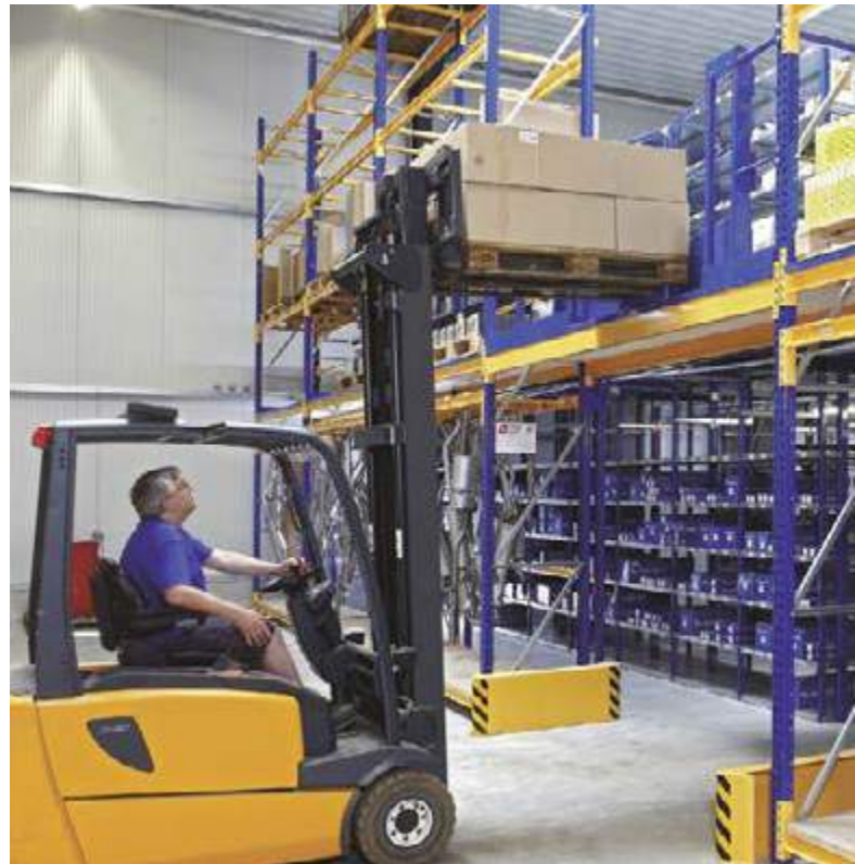
Palettenübergabeplatz in einer 2-geschossigen Regalanlage. Branche KFZ-Teilehandel
