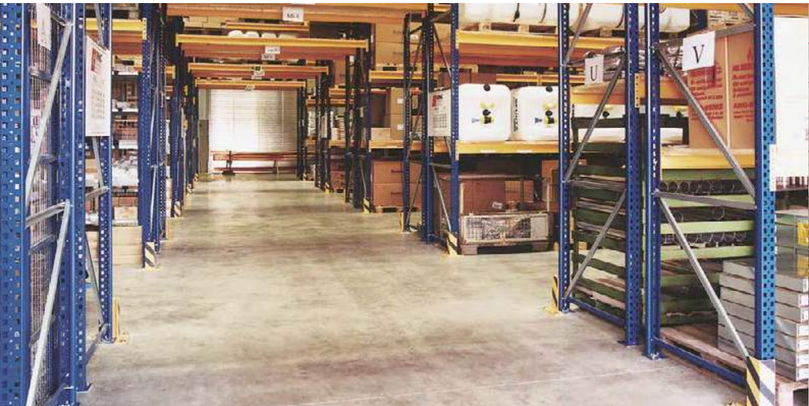
Durchfahrt im Mehrplatz-Palettenregal mit Sicherheits-Abdeckung und Anfahrtschutzkecke
