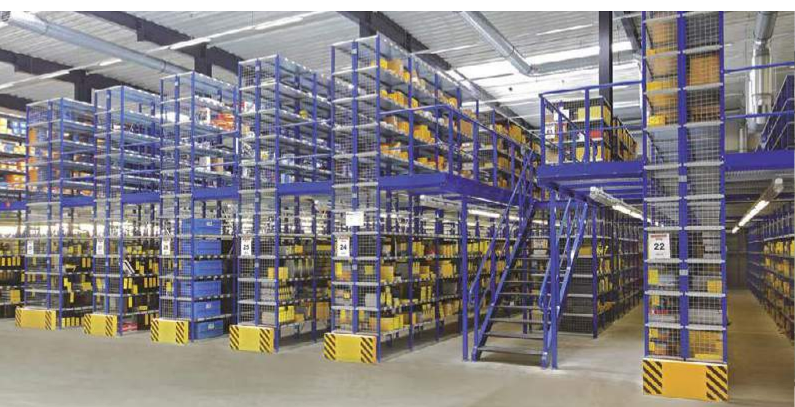
2-geschossige Fachbodenregalanlage mit Treppenaufgang, Schutzgeländer und Gitterstirnwänden.
