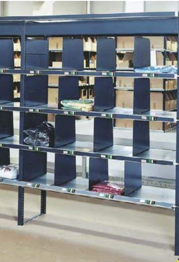
Regal mit Pick-by-light-Anzeigen. Branche: Internet-Versandhandel
