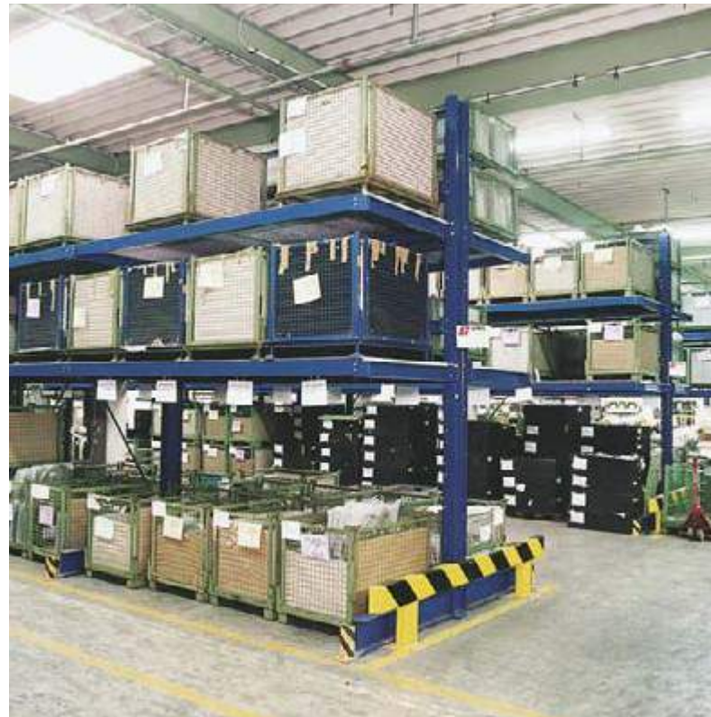
Kragarm-Doppelregale mit durchgehender Gitterrostebene zur Einlagerung von Gitterboxen. Branche: Automobilzulieferer
