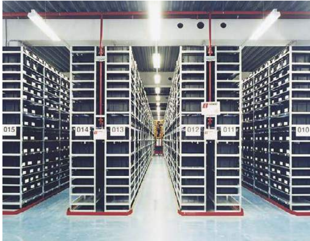
Fachbodenregalanlage für ein ESD-Lager, komplett verzinkt.
