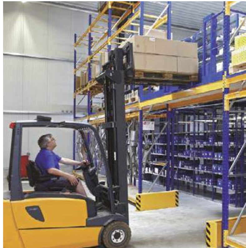
Palettenübergabeplatz in einer 2-geschossigen Regalanlage. Branche KFZ-Teilehandel
