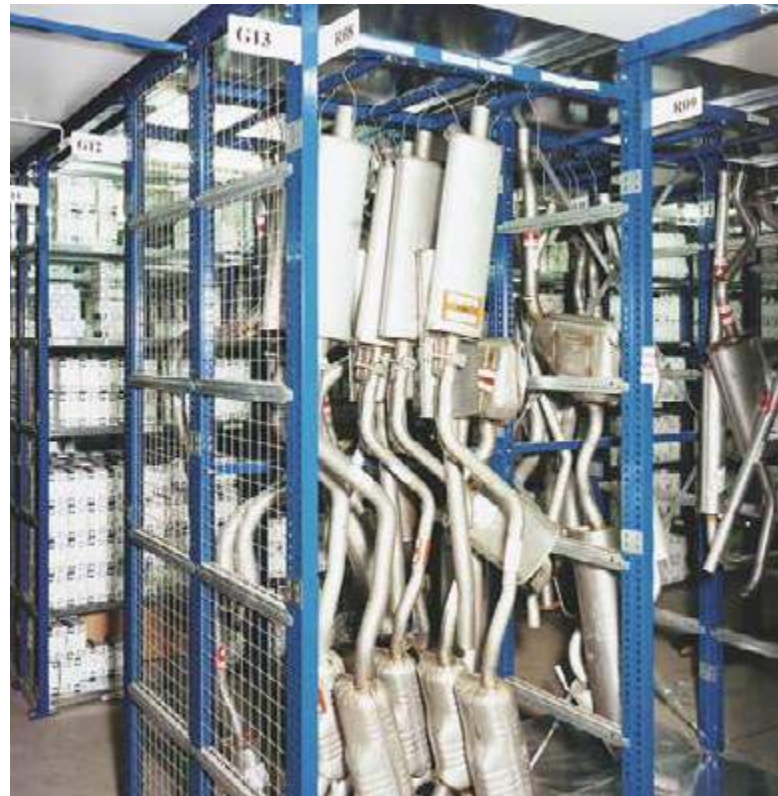
Fachbodenregal für die hängende Lagerung von Schalldämpfern. Branche: KFZ-Teilehandel
