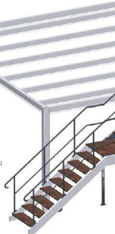
Komplett verschraubte diagonalfreie Rahmenverbindung
