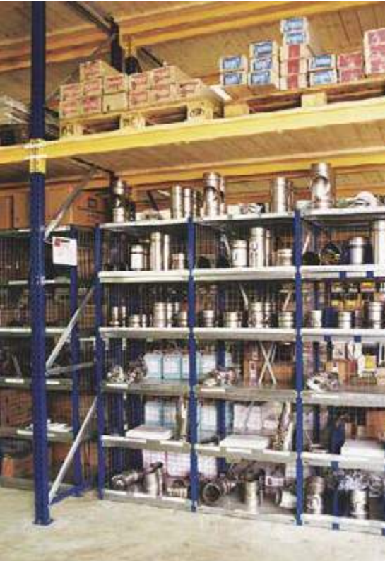
Fachbodenregal eingebettet im Palettenregalfeld mit Gitterseiten- und Rückwänden und Schüttgutleisten.
