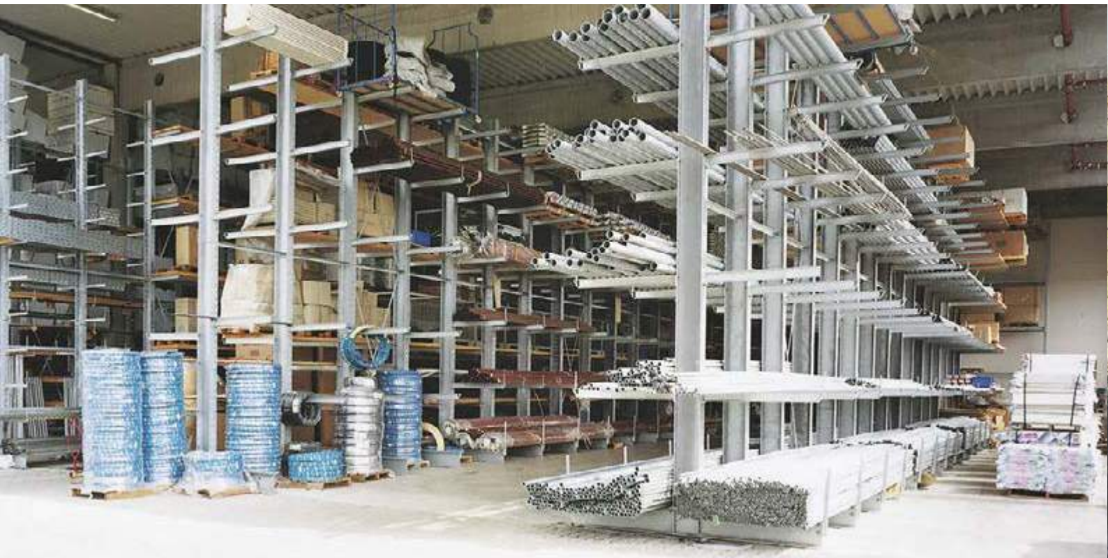
Kragarm-Doppelregale in feuerverzinkter Ausführung mit steckbarer Abrollsicberung. Branche: Sanitärgrößhandel
