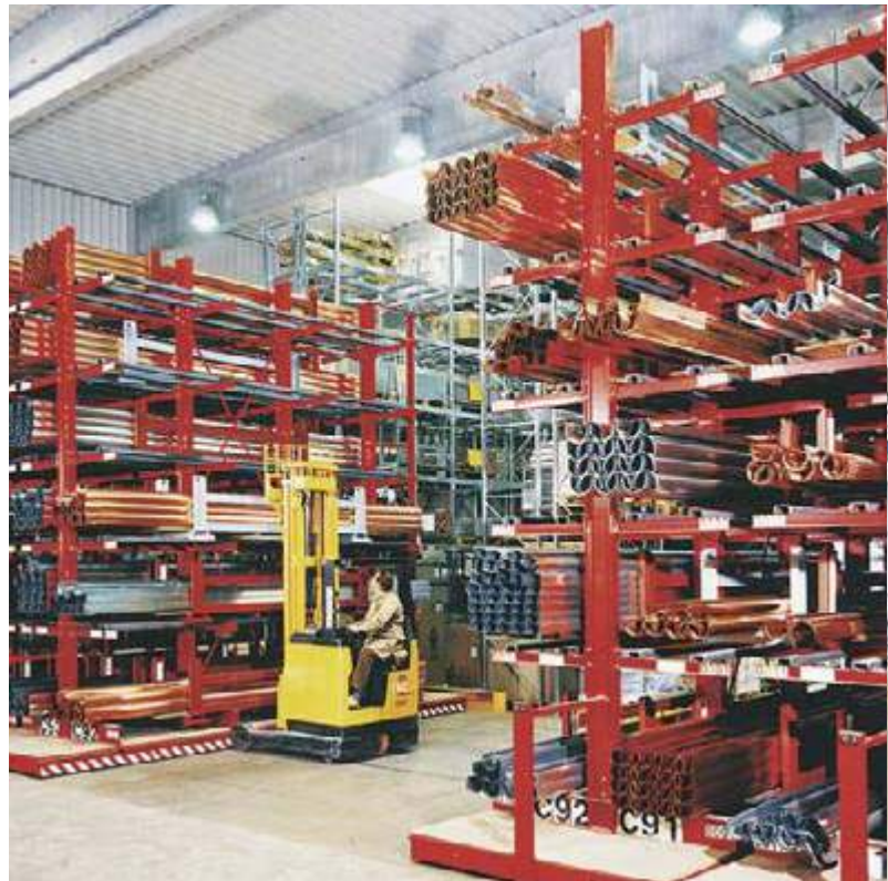
Verfahrbare Kragarm-Doppelregale. Branche: Stahlhandel
