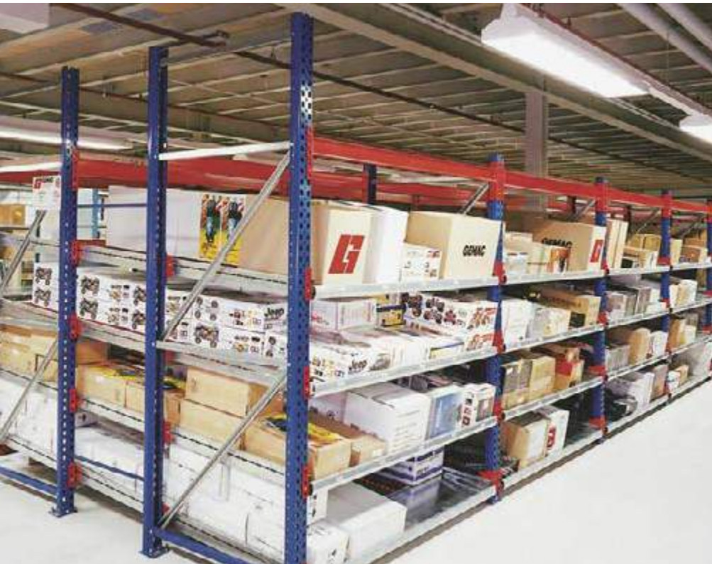
Mehrplatzpalettenregal mit integrierten Durchlaufbahnen für Kartongagen und Behältern. Branche: Versandhandel
