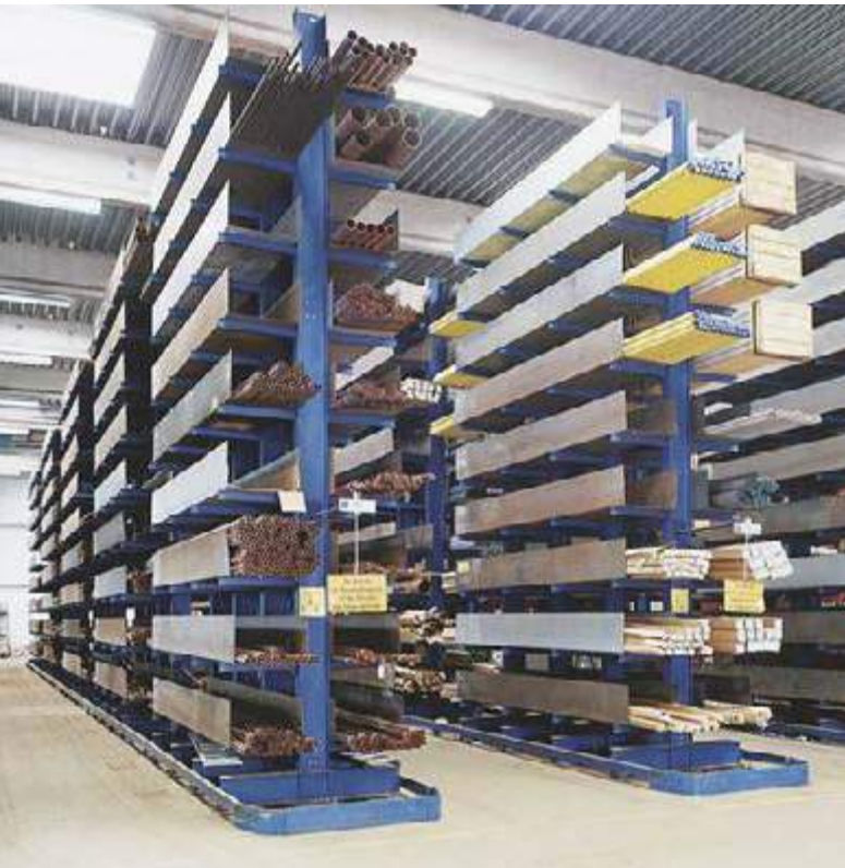
Kragarm-Doppelregale mit Führungsschienen für die Staplerbedienung. Branche: Heizungs- und Sanitärgrößhandel
