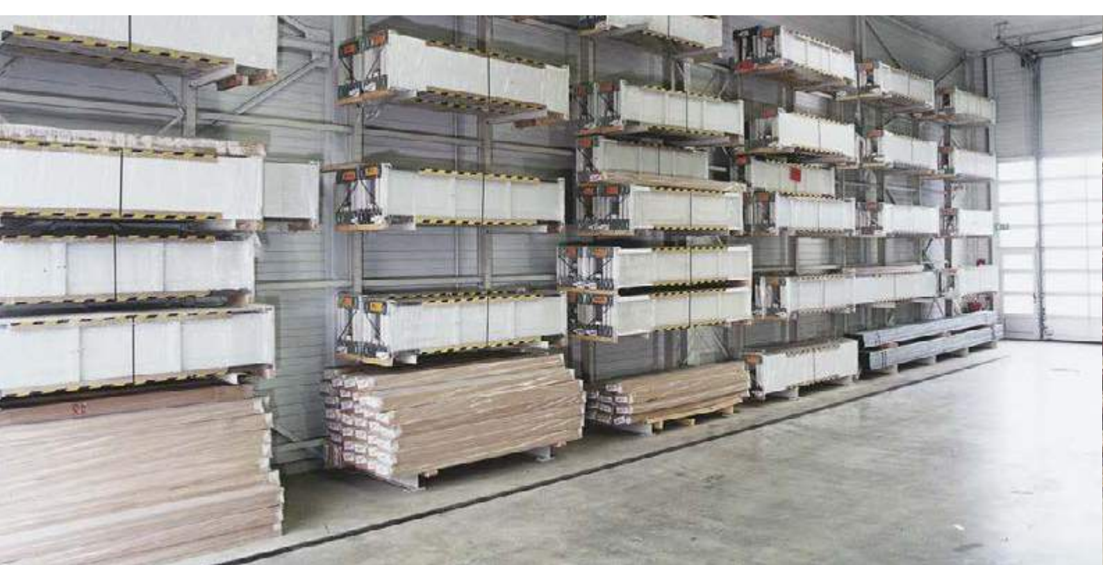
Kragarm-Einfachregale in einem Auslieferungslager eines Herstellers für Türen und Tore.
