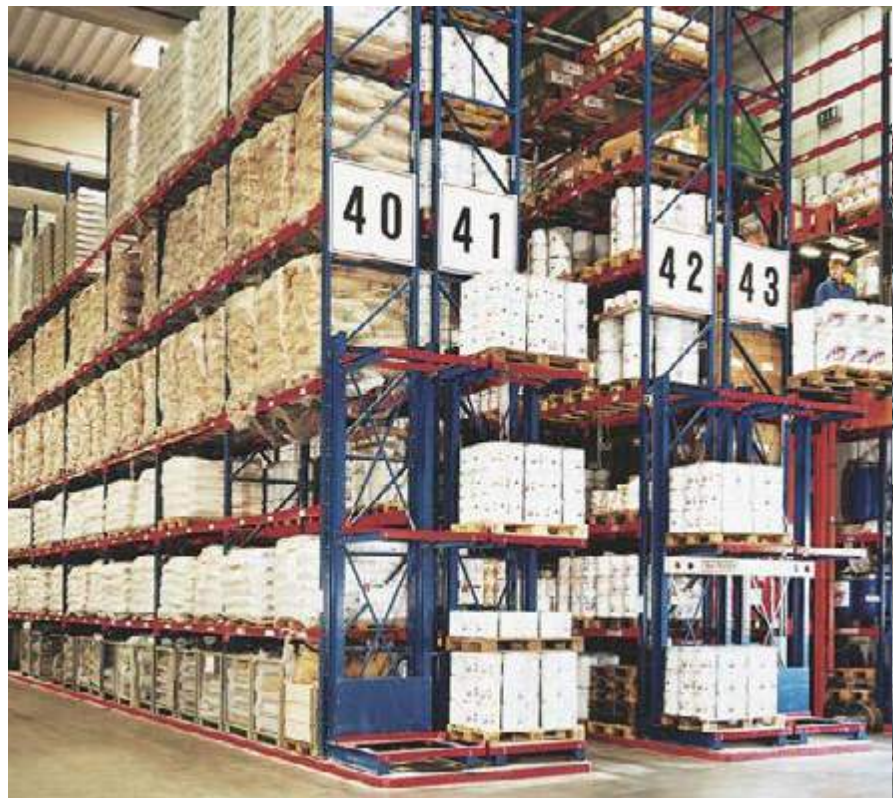
Mehrplatz-Palettenregal mit Führungsschienen. Branche: Chemische Industrie
