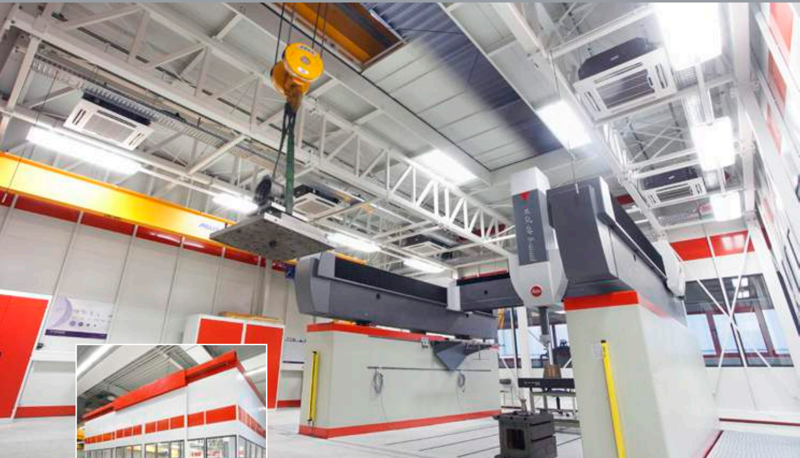
Messraum in der Dimension 12 x 10 x 6 m durch freitragende Fachwerkkonstruktion
