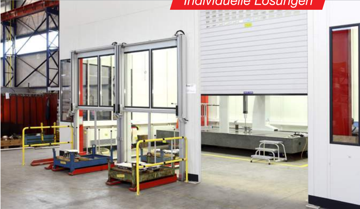
Hallenbüro mit speziellen Schnellaufotoren und kundenseitig integrierten Hubfenstern.
