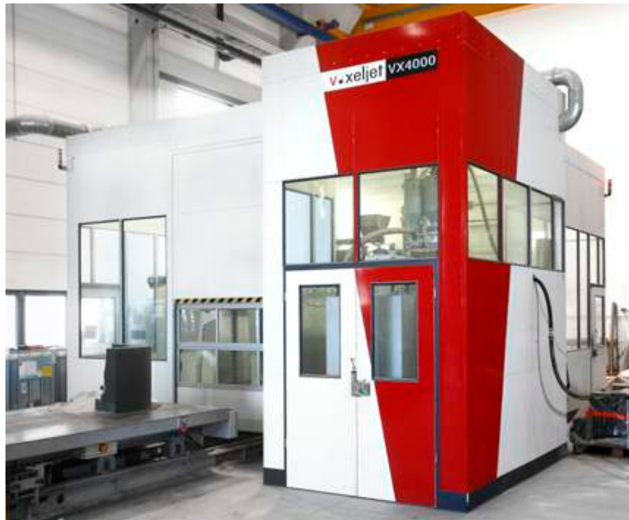
Maschineneinhausung mit bauseitiger Sicherheitseinrichtung und Absaugung.
